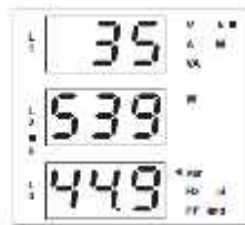
2) Ejemplo de display de kvarh: En este ejemplo la cifra visualizada es 3 553 944.9 kvarh
